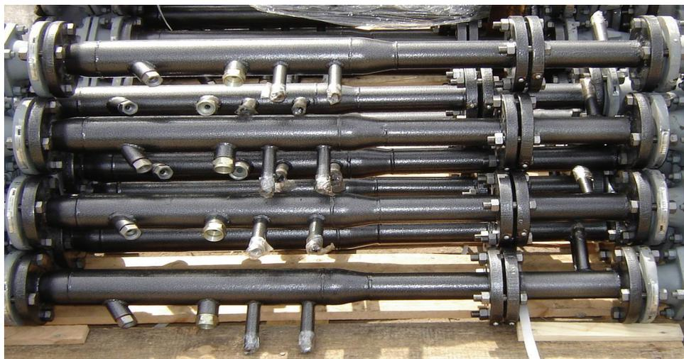
3. **ИЛВ** - измерительная линия узла учета физического расхода холодной или горячей воды. Схематично ее можно представить следующим образом:
