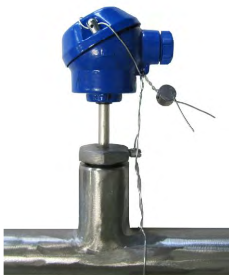
Рисунок 5 - Схема пломбировки ТС (головка типа PL головка)
