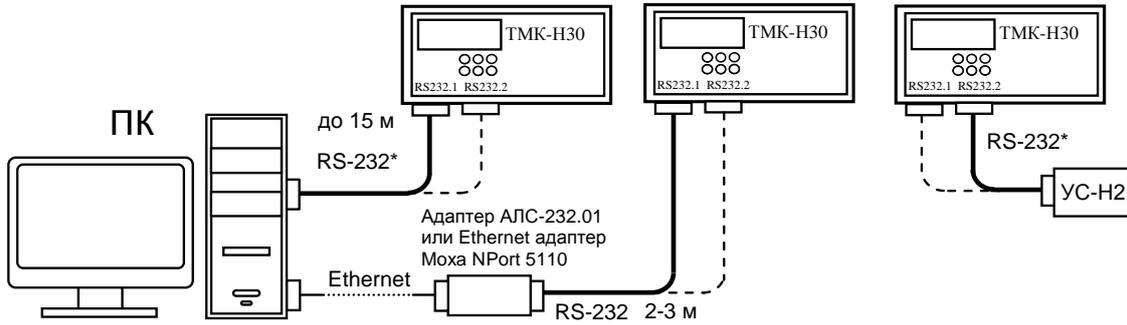
**Подключение сети из ТМК к ПК через конвертер RS232/RS485 или адаптер с использованием сети Ethernet**
