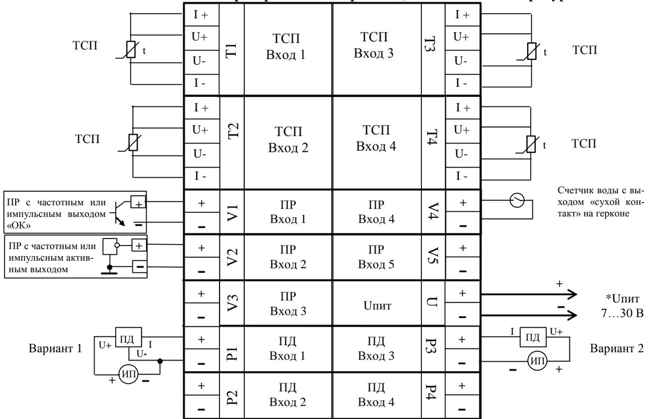
\* Внешний источник постоянного стабилизированного напряжения или аккумулятор
