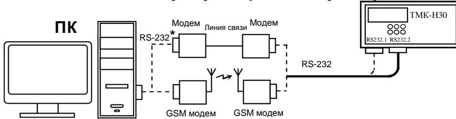
**Подключение сети из ТМК к ПК с использованием адаптера модема (AM-02) по интерфейсу RS485 через проводную или беспроводную линии связи**
