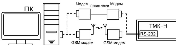
**Подключение ТМК к диспетчерскому пункту по интерфейсу RS232 через AM-02, GPRS модем и Интернет**
