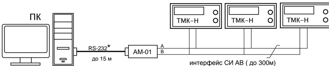
**Подключение до трех ТМК к ПК через адаптер модема АМ-01 и АЛС с использованием сети Ethernet**
