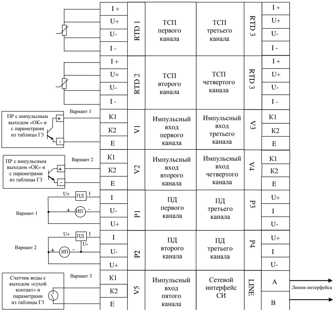
Рисунок Г.1 – Схема подключения преобразователей температуры, расхода и давления к тепловычислителю ТМК-Н13
