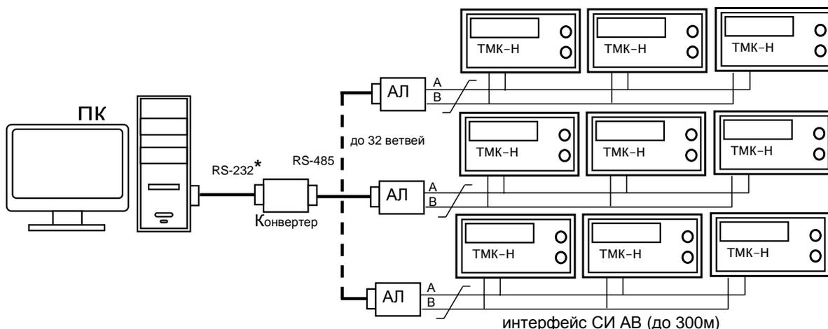
\*- подключение к ПК через интерфейс RS-232 (COM-порт) или через интерфейс USB (USB-порт)
