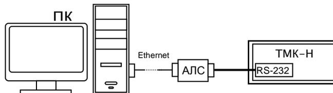
**Подключение ТМК к ПК через проводную или беспроводную линии связи**
