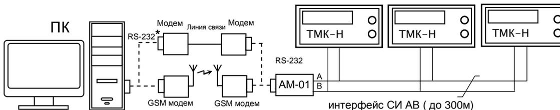
\*- подключение к ПК через интерфейс RS-232 (COM-порт) или через интерфейс USB (USB-порт)
