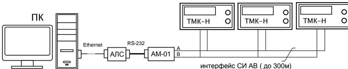
**Подключение ТМК к ПК через проводную или беспроводную линии связи**
