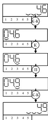
Редактирование служебных параметров (изменение типа реакции на НС Ј, со 2 на 1 во втором контуре)
