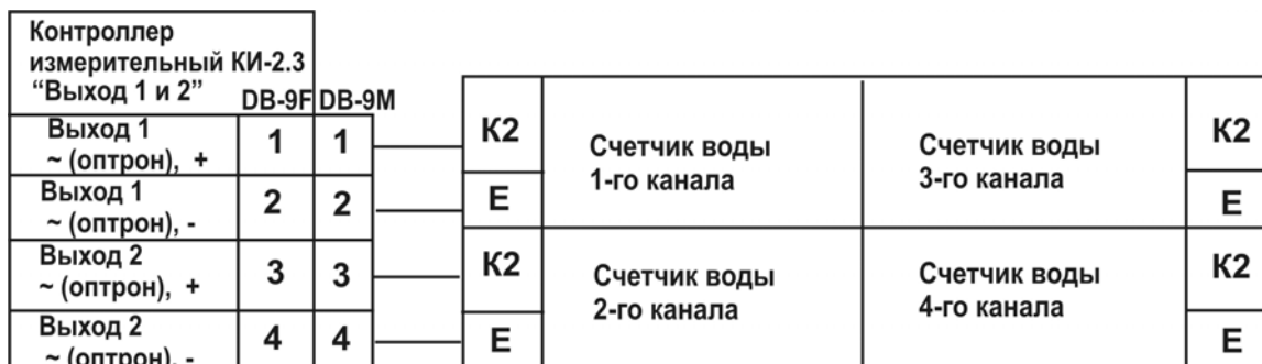
Рисунок Е.2 - Схема подключения вычислителя ТМК-Н5 к контроллеру измерительному КИ-2.3 при использовании в качестве преобразователей расхода счетчиков воды
